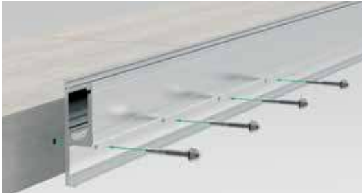
1 Anschrauben des Profils
